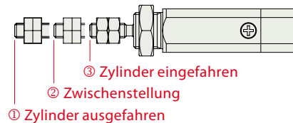
1. Zylinder ausgefahren 2. Zwischenstellung 3. Zylinder eingefahren
